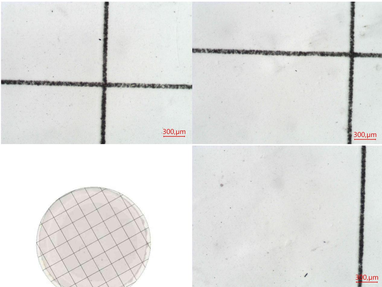
Escasas partículas metálicas ferrosas de hasta 20µm. Escasas partículas carbonosas de hasta 40µm. Escaso hollín. No se observa materia resinosa. Impurezas no identificadas.
