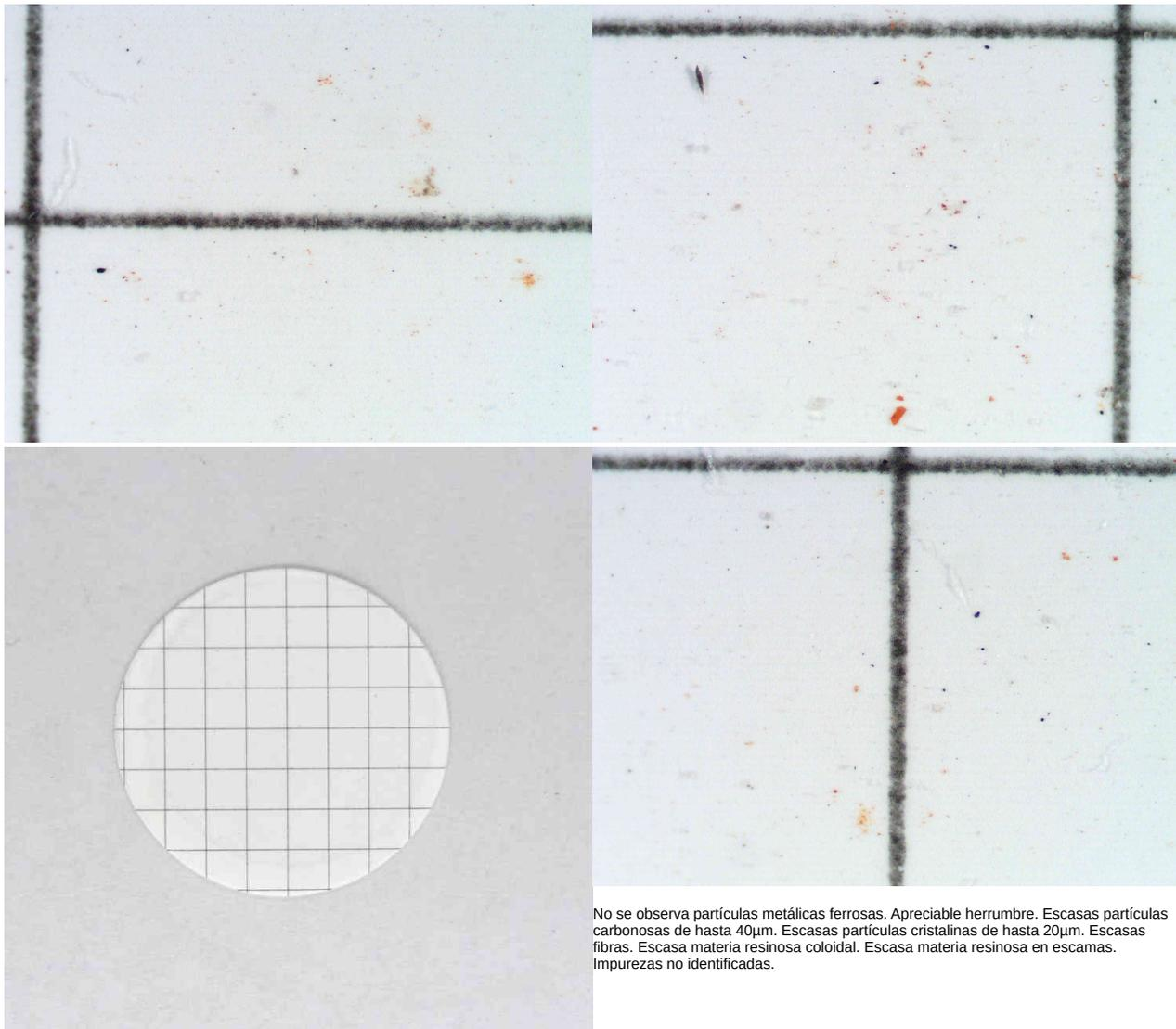
**Análisis espectrométrico (desgaste)**
