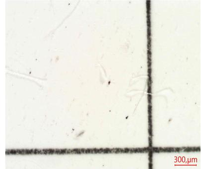
No se observa partículas metálicas no ferrosas. No se observa partículas metálicas ferrosas. No se observa herrumbre. No se observa hollín. Escasas partículas carbonosas de hasta 40µm. Escasas partículas cristalinas de hasta 40µm. Escasas fibras. Apreciable materia resinosa coloidal. Impurezas no identificadas.
