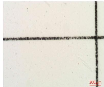
No se observa partículas metálicas ni ferrosas. No se observa partículas metálicas ferrosas. No se observa herrumbre. No se observa hollín. Escasas partículas carbonosas de hasta 30µm. Escasas fibras. Apreciable materia resinosa coloidal. Impurezas no identificadas.
