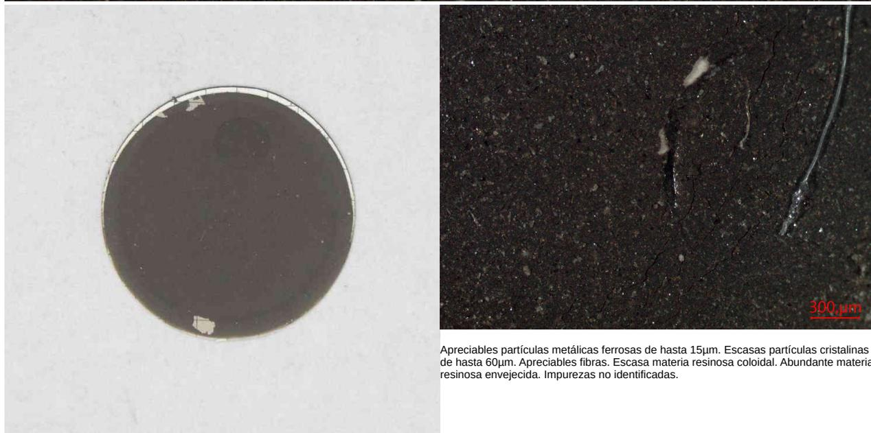
Apreciables partículas metálicas ferrosas de hasta 15µm. Escasas partículas cristalinas de hasta 60µm. Apreciables fibras. Escasa materia resinosa coloidal. Abundante materia resinosa envejecida. Impurezas no identificadas.
