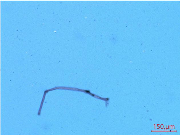
Escasas partículas metálicas ferrosas de hasta 10μm. Escasas fibras. Impurezas no identificadas.
