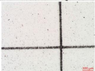
Escasas partículas metálicas ferrosas tipo láminas de hasta
