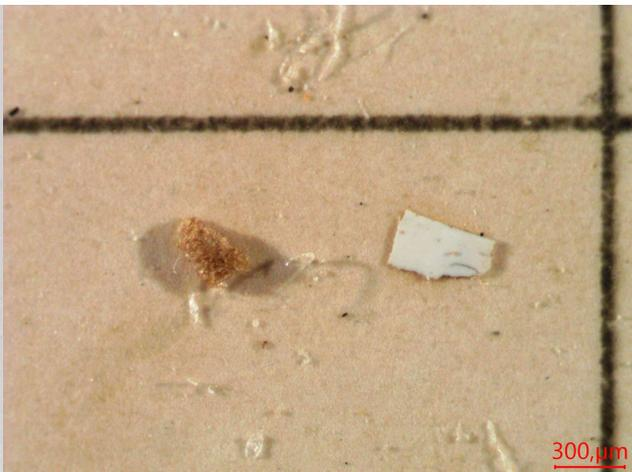
No se observan partículas metálicas. No se observa hollín. Escasas partículas carbonosas de hasta 70µm. Escasas fibras. Escasas partículas cristalinas de hasta 80µm. Apreciable materia resinosa coloidal. Impurezas no identificadas de aspecto resinoso. Impurezas no identificadas.
