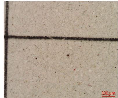
Apreciables partículas metálicas no ferrosas de hasta 50µm.
