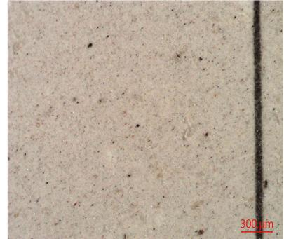
Escasas partículas metálicas ferrosas de hasta 20µm. Escasas partículas metálicas no ferrosas de hasta 50µm. Escasa herrumbre. No se observa hollín. Escasas partículas carbonosas de hasta 30µm. No se observa partículas cristalinas. Escasas fibras. Escaso depósito marrón. Escasa materia resinosa en escamas de hasta 80µm. Impurezas no identificadas.
